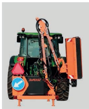
Maaiarm in transport positie. Achterbumper met goed zichtbare verlichting
